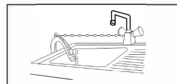
Dans un conduit de vidange (ou dans une dérivation de la vidange d'un lavabo) dont la distance au sol doit être comprise entre 60 et 100 cm. Il est indispensable de prévoir une entrée d'air à l'extrémité du tuyau de vidange pour éviter tout siphonage éventuel. En outre, le tuyau de vidange ne devra former aucun coude. Il devra être placé au niveau du sol, la crosse devra se trouver à la hauteur indiquée précédemment.
