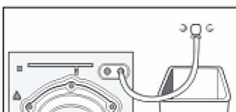
Vissez le raccord du tuyau d'alimentation livré avec l'appareil sur le nez fileté du robinet d'arrivée d'eau (20x27). Vissez correctement pour éviter toute fuite. N'employez jamais à cet effet un tuyau déjà utilisé précédemment.
